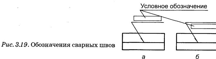
Рис. 3.19. Обозначения сварных швов
